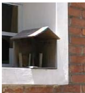
Foto 4 Caseta para discos de corrosividad
